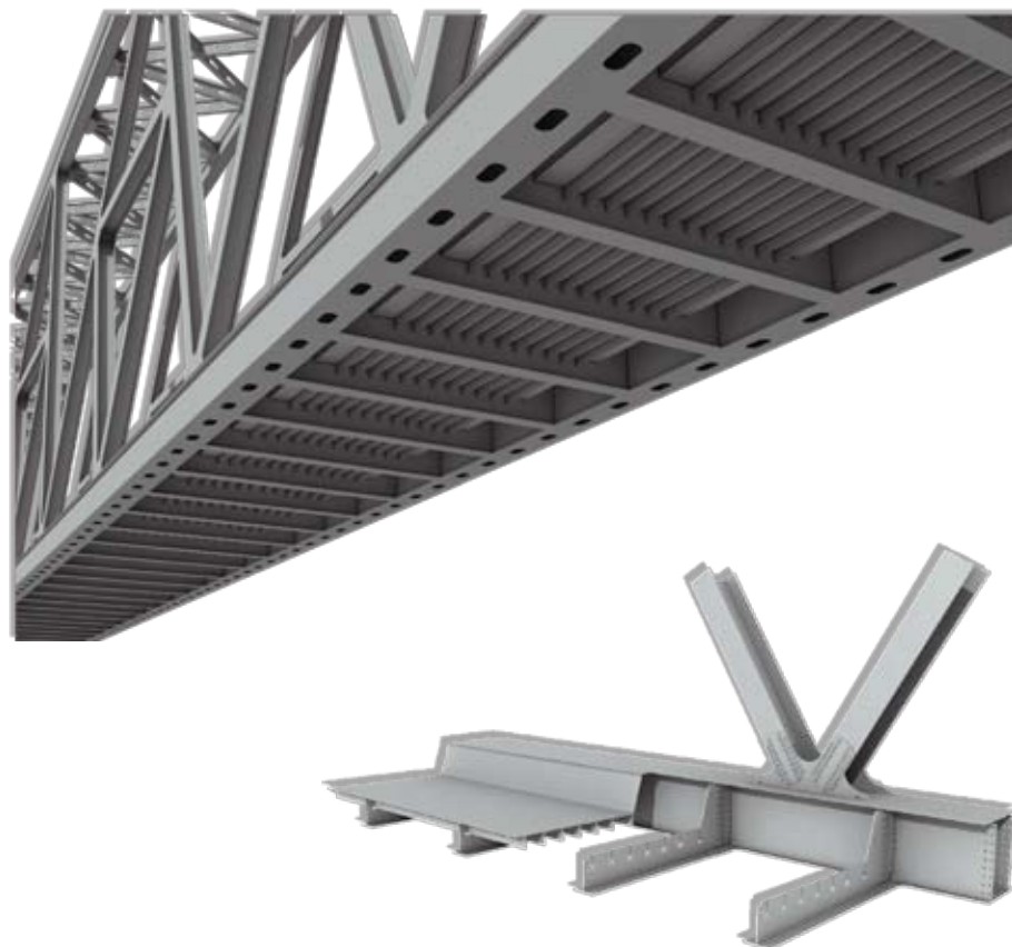
Унифицированные железнодорожные пролетные строения
